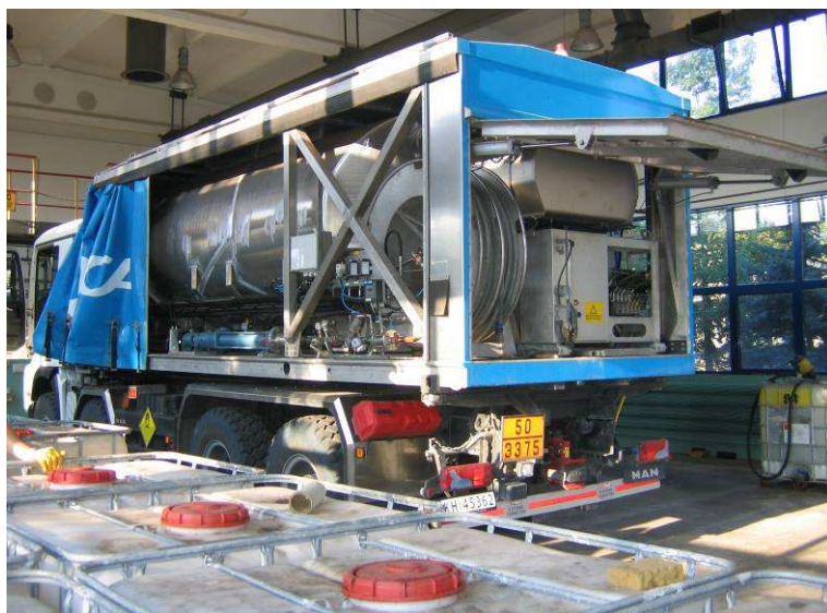
Fot. 4 – Urządzenie MEMU zabudowane jako kontener. Widoczna jest cysterna na emulsję saletry
