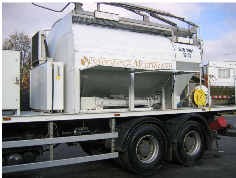
Fot. 7 – Lewa strona pojazdu Explominexu. Za zbiornikiem na emulsję zabudowany jest pojemnik na uczulacz. Widoczna jest pompa tłocząca emulsję.
