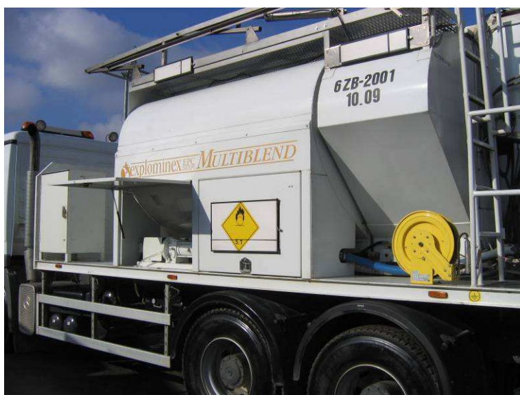
Fot. 8 – Doskonale widoczne nietypowe kształty dolnej części zbiorników na emulsję i uczulacz.
