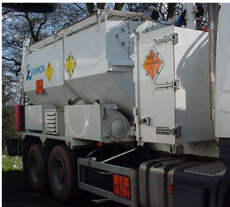
Fot. 15 – Prawa strona tego samego pojazdu. O jego amerykańskim pochodzeniu świadczą pozostawione „placardy” na komorze na materiały wybuchowe i zbiorniku na saletrę amonową. O ile oznakowanie komory na MW jest takie samo wg. amerykańskich i europejskich przepisów, o tyle „placard” na zbiorniku z saletrą został zeuropeizowany poprzez zamalowanie żółtą farbą numeru „1942” znajdującego się w środkowej części oznakowania. Na przedniej ścianie zbiornika znajduje się taki sam „placard”, ale w pozycji zamkniętej
