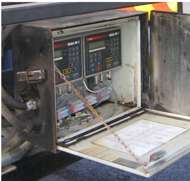
Fot. 3 – Zespół wag elektronicznych służących m.in. do rejestracji ilości załadowanego materiału wybuchowego.
