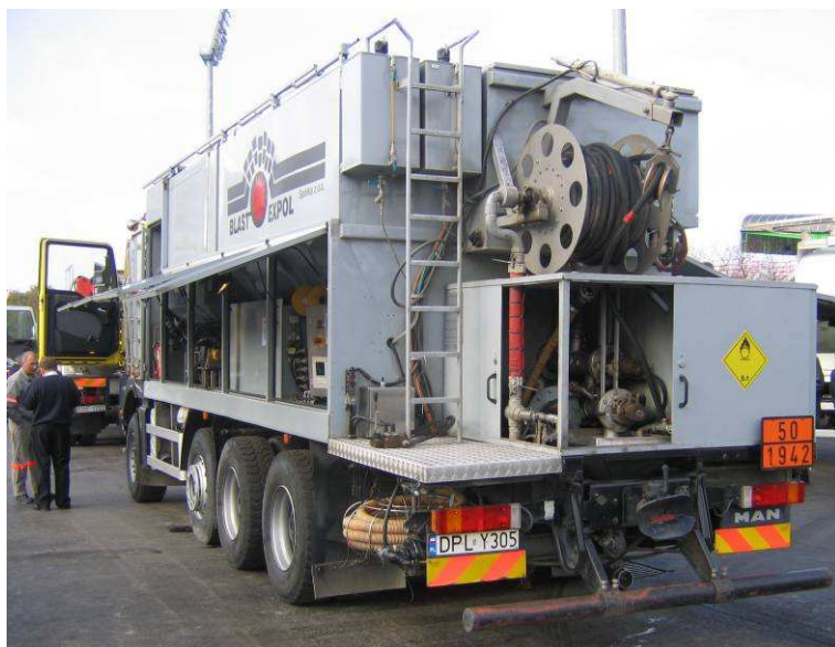
Fot. 11 – Pod pokrywami (na zdjęciach uniesionymi) znajdują się urządzenia do mieszania składników i pulpit sterujący.
