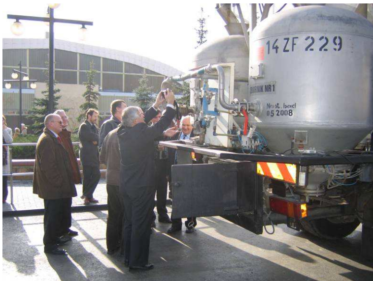
Fot. 2 – Zbiorniki ciśnieniowe do czasowego przechowywania i załadunku ANFO
