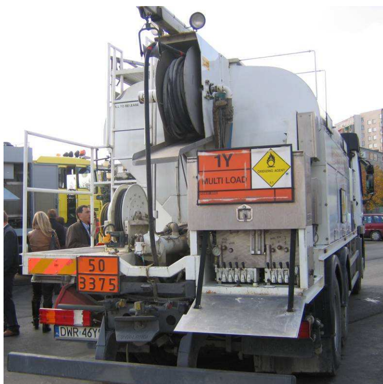
Fot. 9 – Ten sam pojazd w widoku z tyłu. Widoczne zwijadło z węzłem do załadunku MWE do otworów oraz zespół zaworów sterujących. Ciekawe jest też oznakowanie pojazdu świadczące o jego angielskim pochodzeniu.
