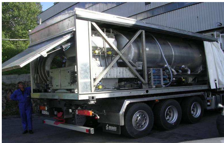
Fot. 5 - Podobny pod względem funkcjonalnym kontener zabudowano również na czteroosiowym podwoziu Volvo, przy czym napędowe są druga i trzecia oś.
