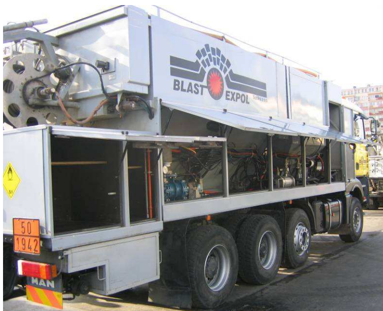
Fot. 10 – UMS 2000 – widok z prawej strony. Komora z tyłu samochodu miała służyć do przewozu ładunków inicjujących!
