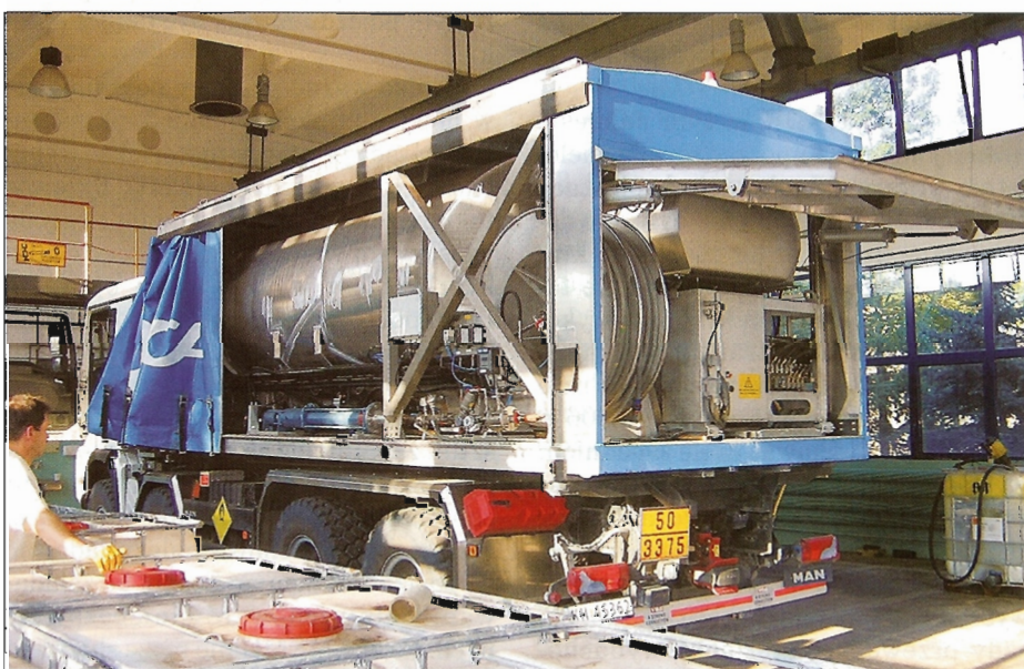
Urządzenie do produkcji MWE zabudowane w kontenerze. Centralnym elementem jest zbiornik na emulsję. Obok znajduje się zwijadło z węzłem służącym do ładowania otworów strzałowych, zbiornik na uczulacz i zespoły zaworów
